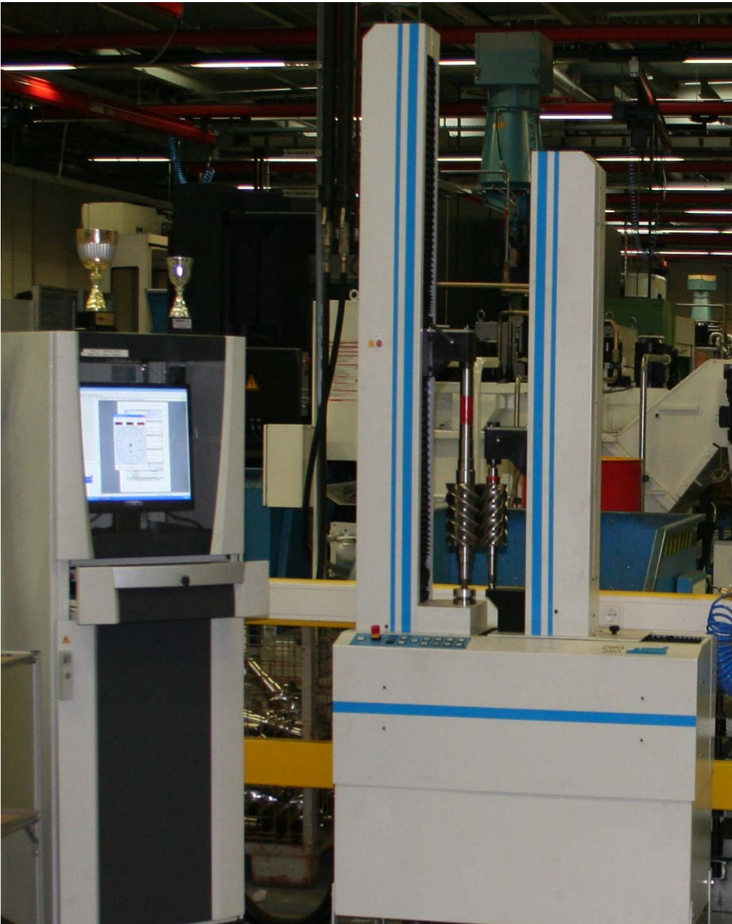
Extrudermessungen mit einer Einspannlänge von 1,8m.
