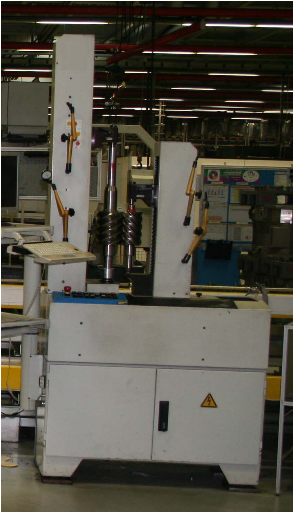
Extrudermessungen mit einer Einspannlänge von 0,7m. An den zusätzlichen Messsteilen können Messtaster zur Kompensation der Lagerstellen angeschlossen werden.
