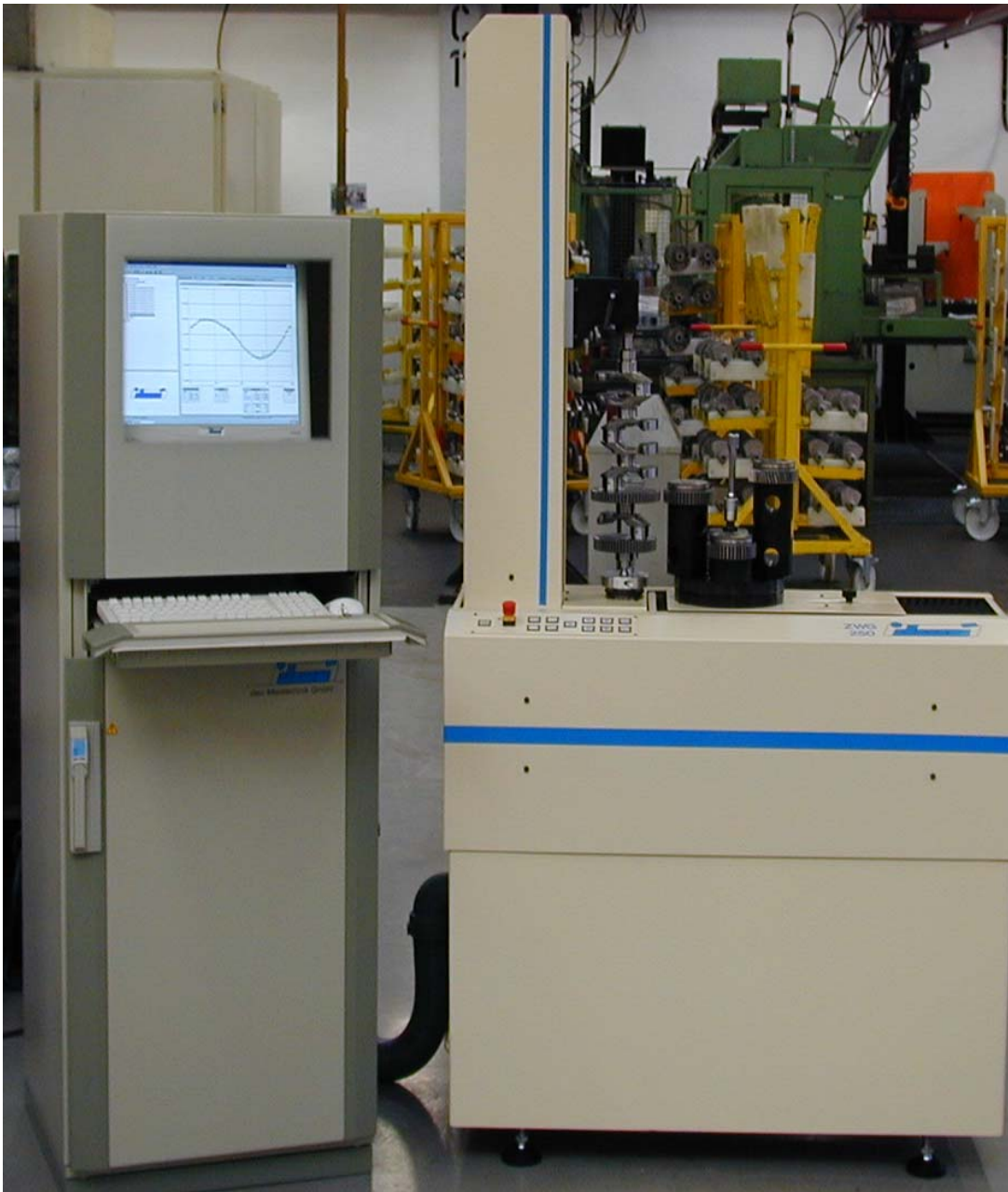
Einsatz bei BMW Berlin zur 100% Kontrolle der Steuerungszahnräder auf der Kurbelwelle.
